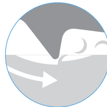
2ラウンドフルーテッドバーULマイルドタイプの例： 特殊加工が施されている刃先
